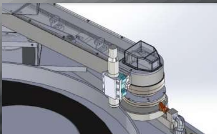
CMP PAD量測設備
